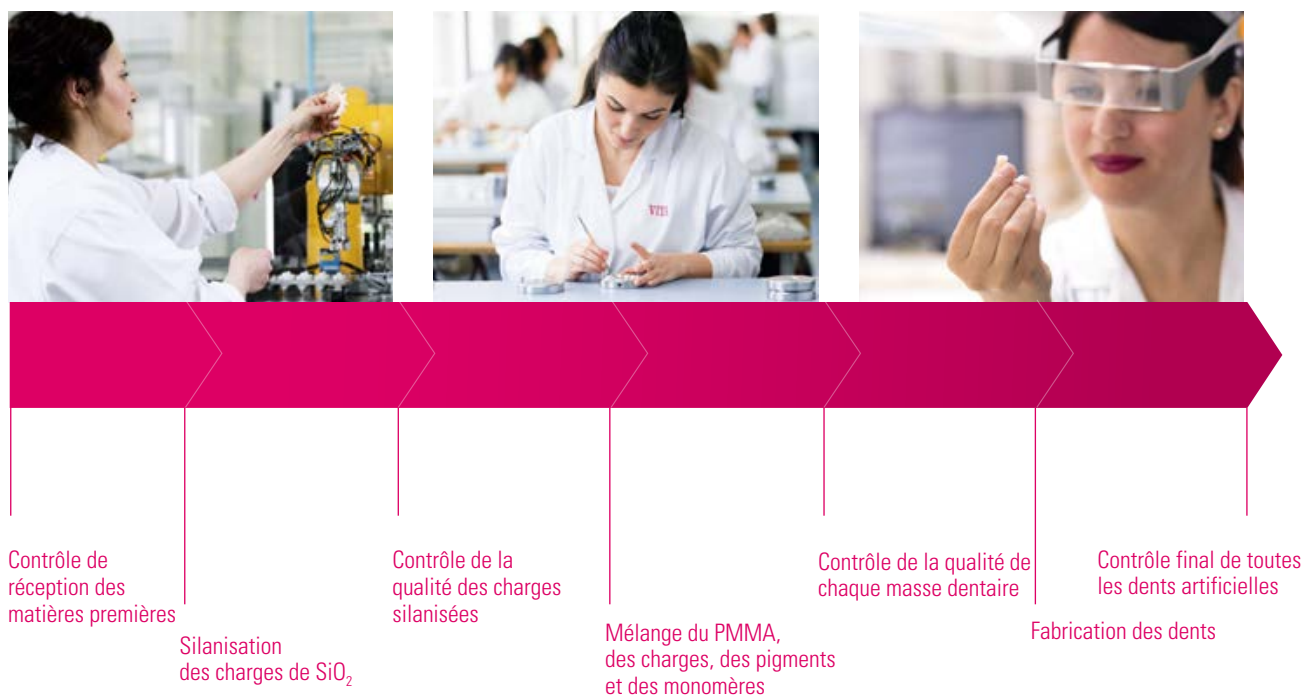
Illustration 9 : processus de fabrication des dents artificielles VITA ; source : R&D VITA
