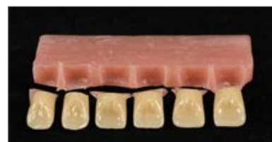
Illustration 15 d : schéma de rupture ; seul un adhésif a été appliqué sur la base de la dent
