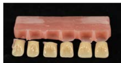
Illustration 15 b : schéma de rupture ; aucun prétraitement des surfaces de la base de la dent
