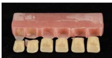
Illustration 15 c : schéma de rupture ; prétraitement de la base dentaire uniquement par sablage
