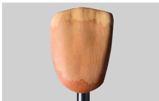
Couronne après la troisième étape d'infiltration
