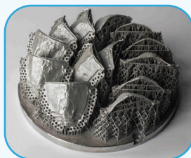
Plateaux en Chrome Cobalt (gauche) et en Titane (droite) réalisés avec l'imprimante 3D NCL-M150
