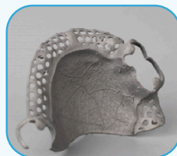
Polissage électrolytique au plasma réalisé par la NCL -API0
