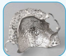
Polissage électrolytique au plasma réalisé par la NCL -API0
