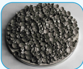
Plateaux en Chrome Cobalt (gauche) et en Titane (droite) réalisés avec l'imprimante 3D NCL-M150
