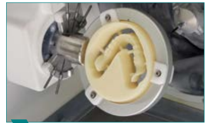
3 Fraiser le disque de cire pour la prothèse en cire pour l'essayage (mandibule).
