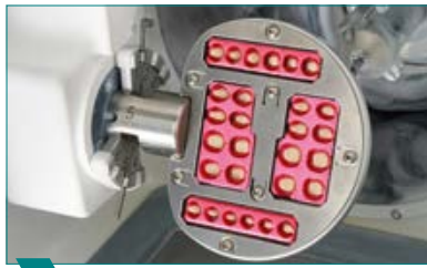
2 Les dents prothétiques après modification par FAO.
